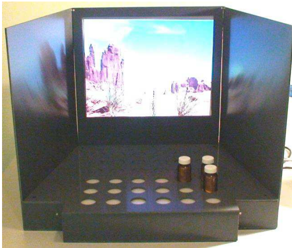
Figure 20. Dispositif expérimental. Lors de l'encodage d'un épisode, 3 flacons odorants sont placés sur 3 emplacements groupés de la planche, dans un contexte visuel représenté par la photographie d'un désert.
